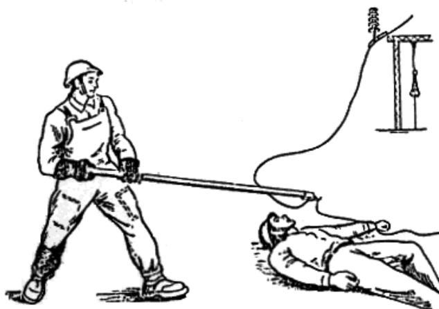
**Рис.7. Освобождение пострадавшего от действия тока в установках выше 1000 В отбрасыванием провода изолирующей штангой**
